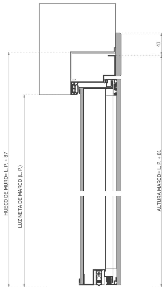
SECCIÓN VERTICAL VISTO EXTERIOR (MEDIDA) CUOTA P E H NECESARIA
